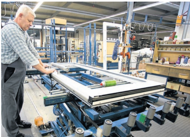
Früher wurden die Türen an einzelnen Stationen schrittweise gefertigt, mit der neuen Produktionsstraße verläuft die Produktion in Zukunft kontinuierlich bis zur Verpackung auf einer Rollenbahn.
